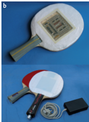
Abb. 1 a–b: Timo Boll, der deutsche Weltklasse-Spieler (a). Er sieht mehr (und besser) als andere. Auf der rechten Seite (b) ist ein Mess-Schläger – der sog. Treffpunkt-»Analyser« – abgebildet, mit dem die Präzision der Schläge erfasst werden kann (vgl. auch Abb. 2).
